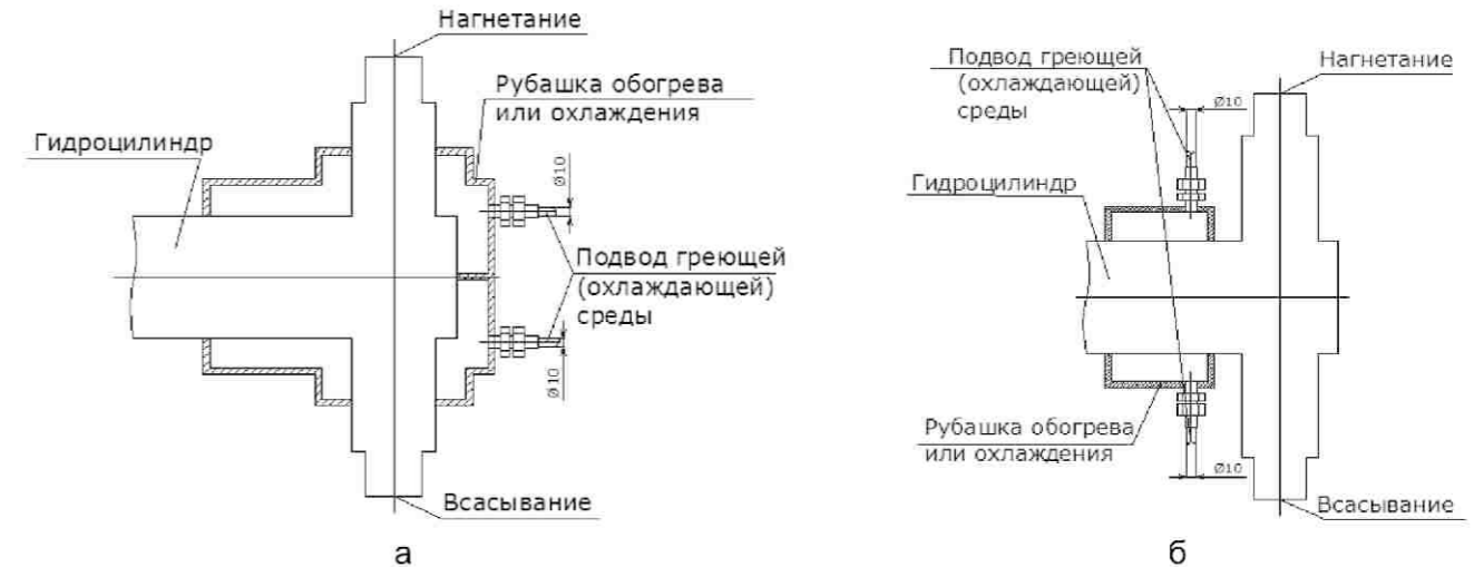
Рис.8.1 Варианты исполнения рубашки обогрева или охлаждения гидроцилиндра
